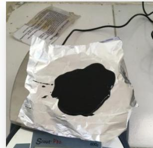
Penimbangan ekstrak etanol kulit batang bererenuk
