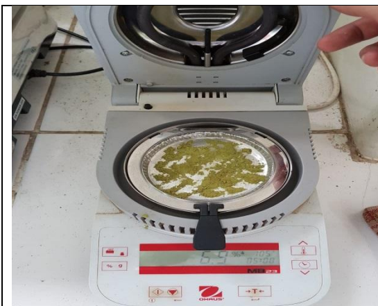
Pengukuran kadar pengeringan daun jambang dataran rendah sebesar 6,9% dengan alat moisture balance
