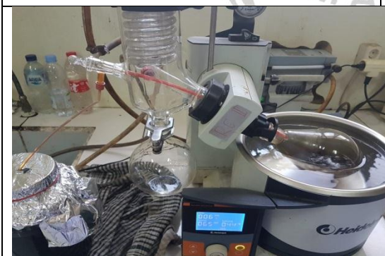
Proses pembuatan ekstrak menggunakan rotary evaporator
