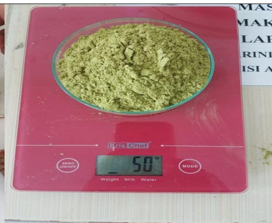
Penimbangan serbuk untuk di ekstraksi dengan ultrasonik sebesar 50 gram
