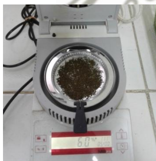
Pengecekan kadar air simplisia
