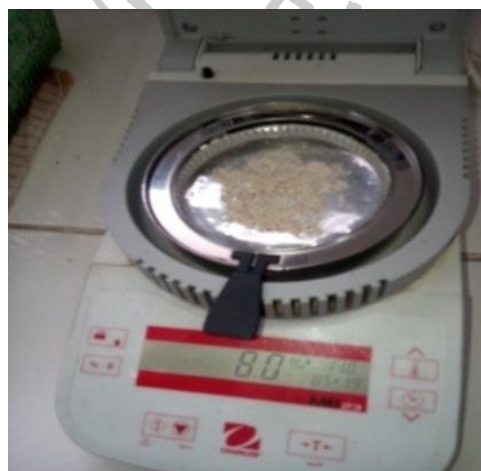
Proses pengecekan kadar air serbuk simplisia
