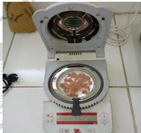
Pengecekan Kadar Air Simplisia Kulit Batang Kersen
