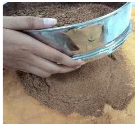
Menyeragamkan Ukuran Serbuk Kulit Batang Kersen Menggunakan Ayakan Mesh no.40
