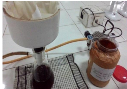
Penyaringan maserat menggunakan corong buchner dan vakum
