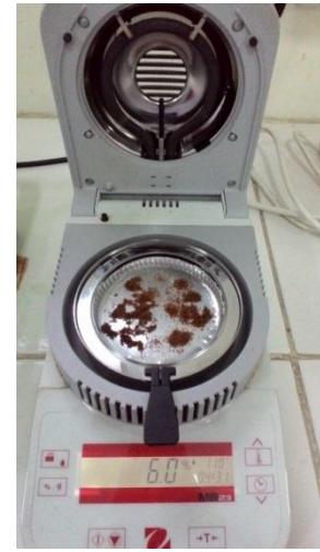
Pengecekan kadar air simplisia menggunakan moisture balance
