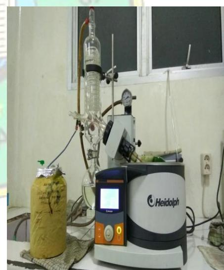
Proses rotary evaporator ekstrak
