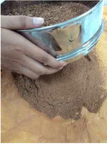
Menyeragamkan ukuran serbuk dengan ayakan mesh no.20
