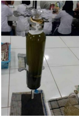
Proses ekstraksi daun kersen dengan metode Perkolasi
