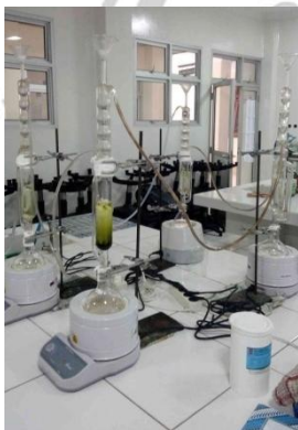
Proses ekstraksi daun kersen dengan metode Sokletasi
