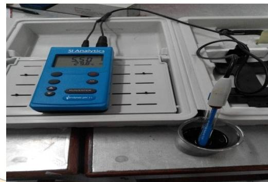
Alat pH meter untuk uji pH sirup
