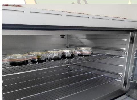
Proses inkubasi sirup pada suhu 37°C
