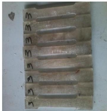
Gambar I.1. Spesimen Uji Tarik Komposit.
