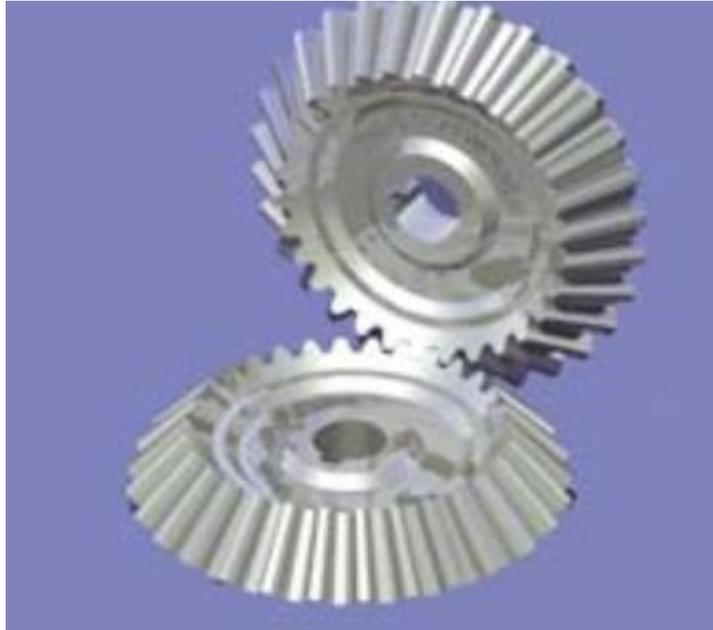
*Gambar II. 21 Roda gigi Kerucut Lurus
