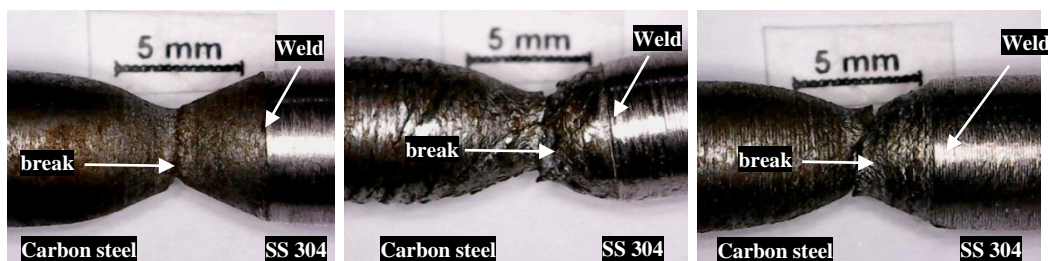
Gambar 3.18. Hasil fisik pengujian tarik sambungan las gesek antara stainless steel dengan baja karbon (Purwanto et al., 2020)
