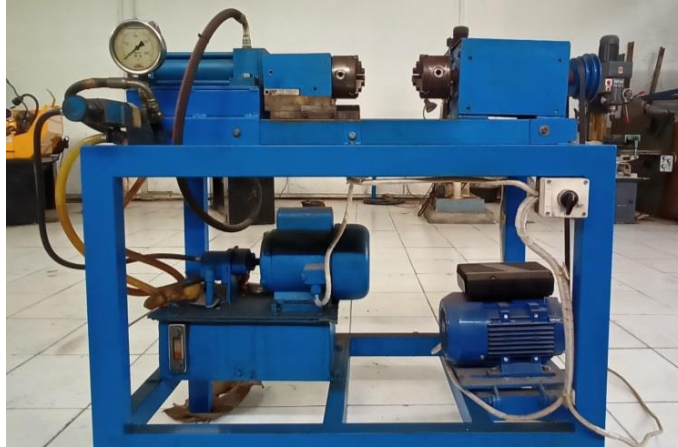
Gambar 3.11. Mesin las gesek hasil rancang bangun pandangan depan
