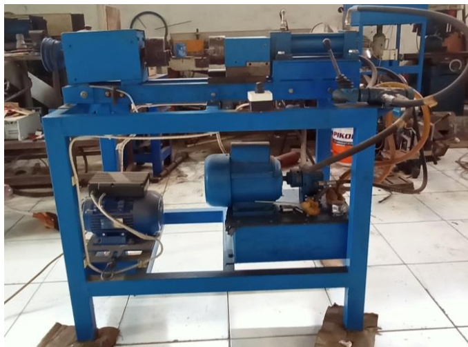
Gambar 3.12. Mesin las gesek hasil rancang bangun pandangan belakang
