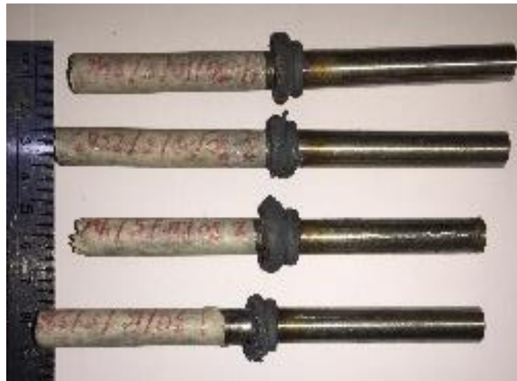
Gambar 3.15. Hasil las gesek poros as bahan stainless steel dengan baja karbon (Purwanto et al., 2020)
