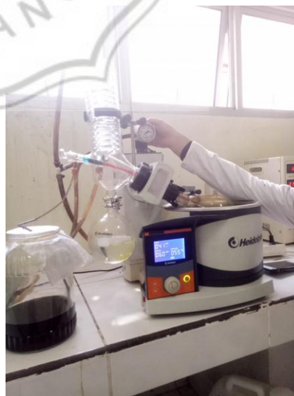
proses pengentalan ekstrak dengan RE
