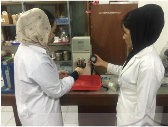
Proses pengukuran waktu Alir granul
