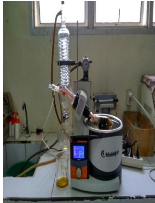
Proses ekstraksi dengan menggunakan alat rotary evaporator
