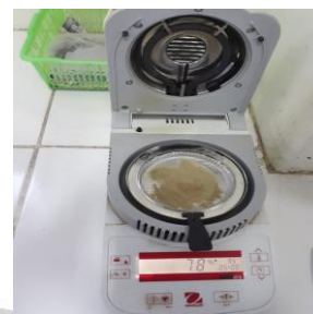
Pengecekan kadar air menggunakan moisture balance
