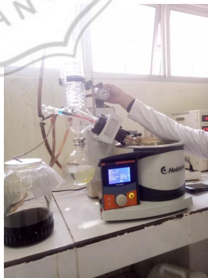
proses pengentalan ekstrak dengan RE
