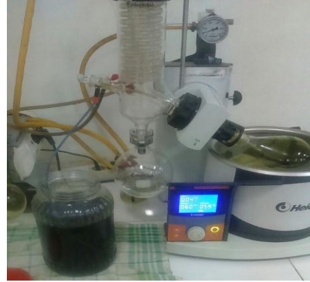
Proses Rotary Evaporator (RE) Ekstrak Etil Asetat Daun Pandan Wangi
