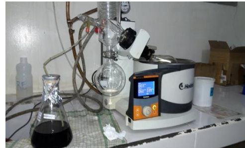
Proses pengentalan ekstrak dengan Rotary evaporator
