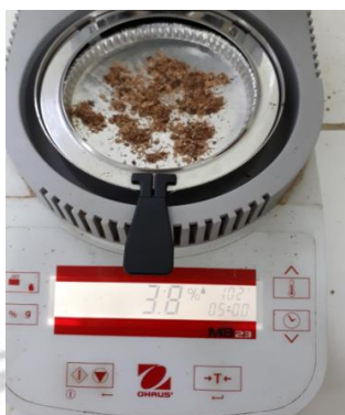
Pengukuran kadar air menggunakan moisture balance
