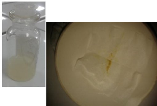
Hasil RE kemudian dilarutkan dalam aseton dan difiltrasi
