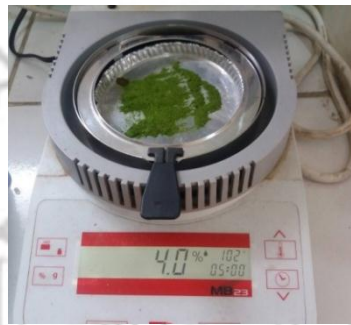
Pengecekan kadar air
