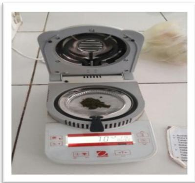
Pengukuran kadar air serbukdaunkersendengan moisture balance
