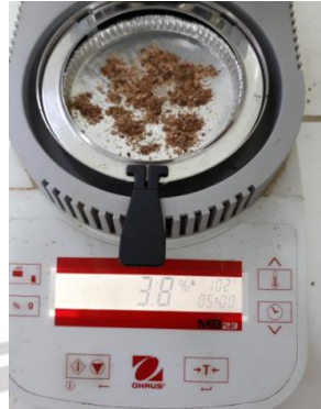
Pengukuran kadar air menggunakan moisture balance
