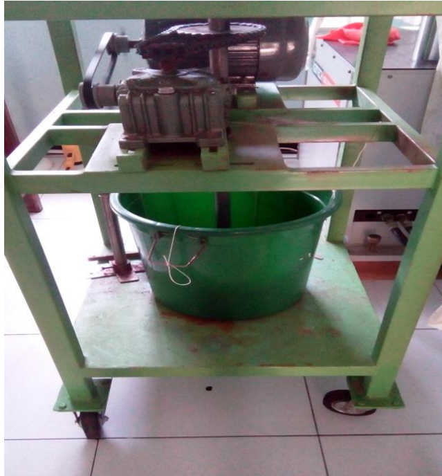
Gambar C.3 Mesin untuk pengujian laju korosi metode putar
