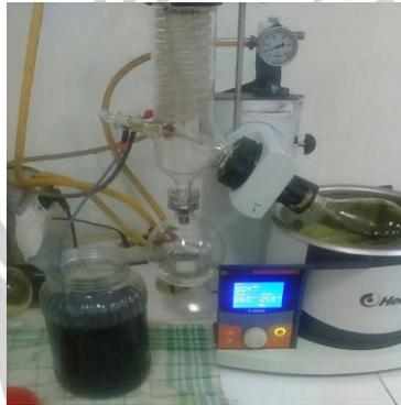
Proses rotary evaporator ekstrak etanol
