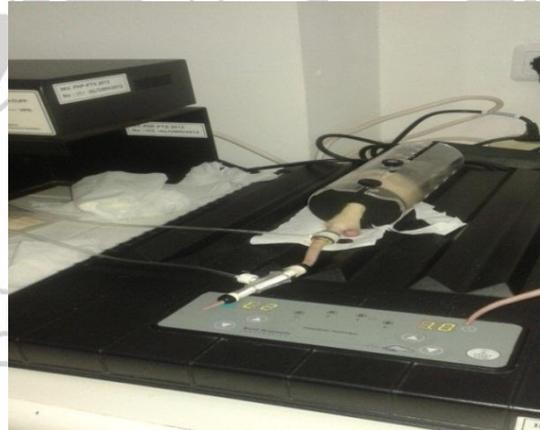
Proses pengukuran tekanan darah menggunakan alat CODA
